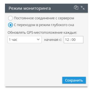
1. ПОСТОЯННОЕ СОЕДИНЕНИЕ С СЕРВЕРОМ. Данный вариант предусматривает постоянное соединение с сервером системы мониторинга «ГдеМои» по GSM/GPRS каналу. Это необходимо для удаленной конфигурации устройства или обновления программного обеспечения до актуальной версии.
